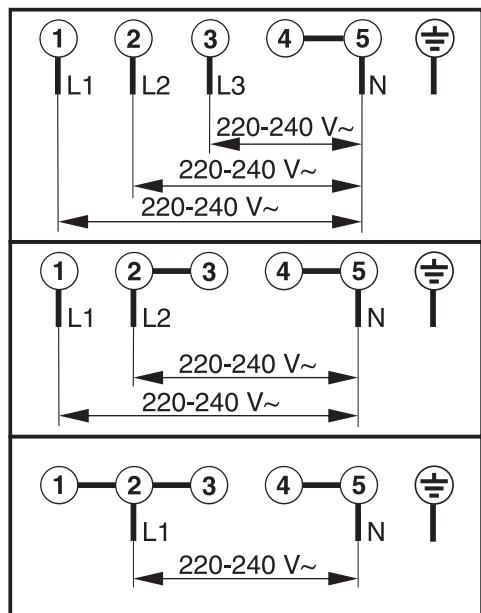
Внимание! Это изделие сконструировано для подключения к сети переменного тока с защитным (третьим) проводом заземления (зануления), которое соответствует требованиям п.7.1 "Правил устройства электроустановок".
